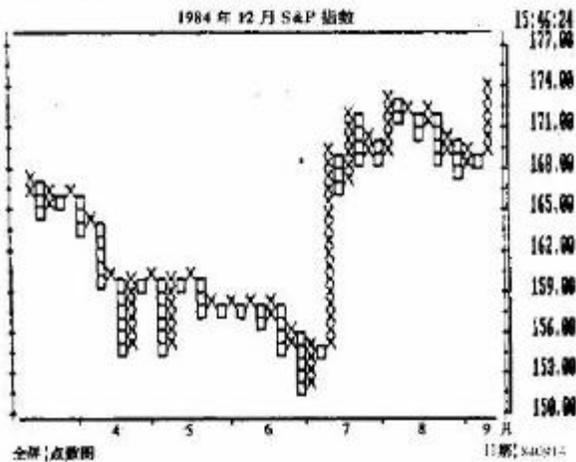
图11.3和11.4还展示了点数图的另一大优势——灵活性。从图11.2到图11.4,所有点数图显示的都是完全一致的价格内容。在三张图上,每一点(每个O或X)均代表1.00,即1个指数价格的点。在图11.2中,我们采用的是一点转向规定。这就是说,其中把每个单点反转都显示在图上。我们有两个办法来修改点数图——改变每点代表的数值,或者改变转向规定(即每次转向所要求的点数)。通过改变转向规定的点数,我们可以得出不同的图形。请注意,在图11.2中,共有47列。在图11.3中,我们把单点转向规定修改为三点转向规定,结果把价格变化大为浓缩了。请注意,这里的列数已经从47列减少到26列了。图11.4采用五点转向规定,进一步压缩了价格资料。这张图的列数几乎再减去了一半,仅有14列。
